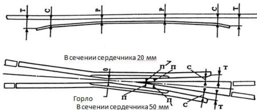
Рисунок 3.4 – Места контрольных измерений ширины желобов в острых крестовинах и контррельсах
