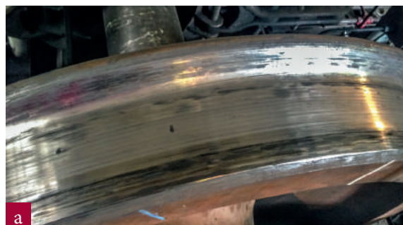
Рис. 5. Результаты стендовых испытаний моделей тормозных колодок: объемный износ
